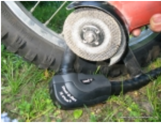
Abus Granit Steel-O-Flex X-Plus 1025 gegen Flex
